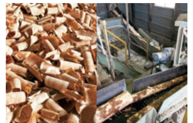
写真右が間伐材を削る「ウッドマットマシン」、左が敷料「エココールマット」
