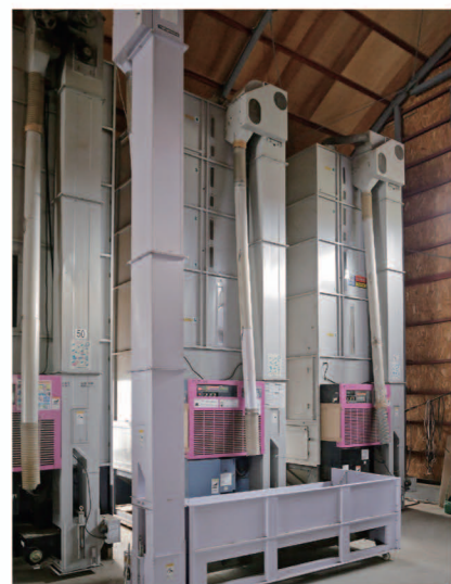
写真は通風乾燥機。その他遠赤外線(火力)乾燥機も複数台備えており、より高品質の調整を目指している
